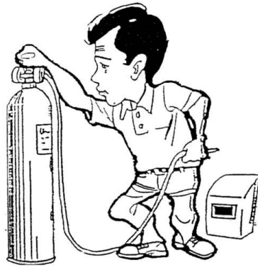
ก่อนทำการเชื่อม ต้องตรวจสอบความพร้อมของตัวปรับแก๊ส และสายหัวเชื่อมก่อน
